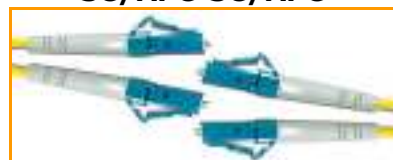
LC/PC-LC-PC y LC/PC-LC/APC
